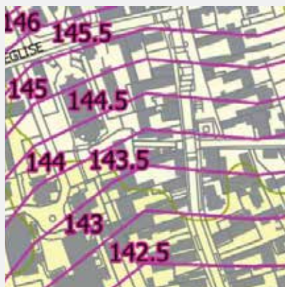
Figure n°8 : Extrait du plan de zonage réglementaire B « Zones de remontée de la nappe phréatique » (Les lignes roses sont des lignes d'isocotes qui délimitent les zones ayant la même cote piézométrique.)
